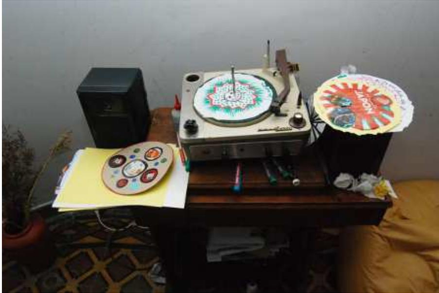
Pieza interactiva de hardware reciclado, diseñada para realizar sonidos electrónicos provenientes de osciladores a partir de discos con imágenes. A partir de un viejo Wincofon, un motor de impresora recuperado y un servomotor, se realizaron los circuitos electrónicos y las adaptaciones mecánicas necesarias.
